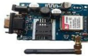
Figure.5. GSM module
