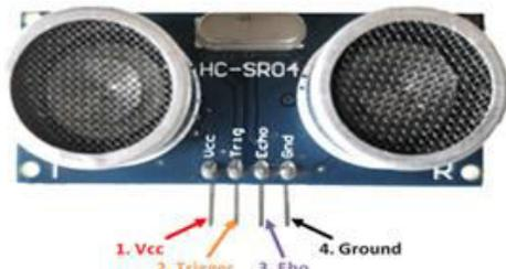
Figure.4. Ultrasonic module
