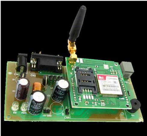
Figure.3. GSM module
