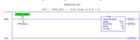
Figure. 9. Program for generator protection using PLC (d)
