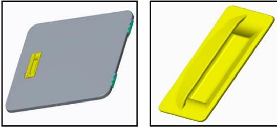
Figure 2. A) door assembly b) handle
