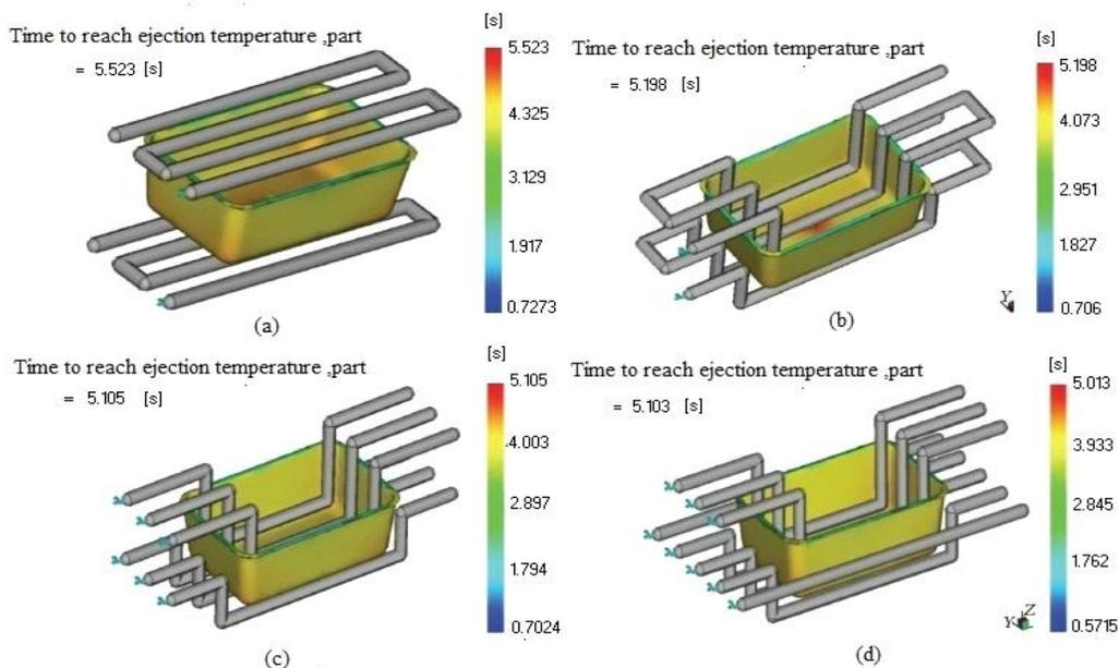
**Figure.6. Time to reach part ejection temp (a) CCC (b) SCC (c) PCC (d) CCAL**
