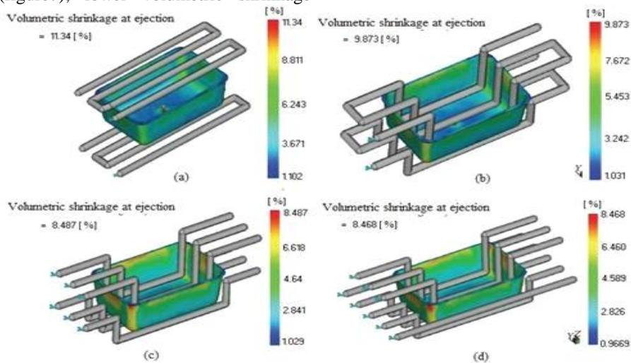
Figure.8. Volumetric Shrinkage (a) CCC (b) SCC (c) PCC (d) CCAL
