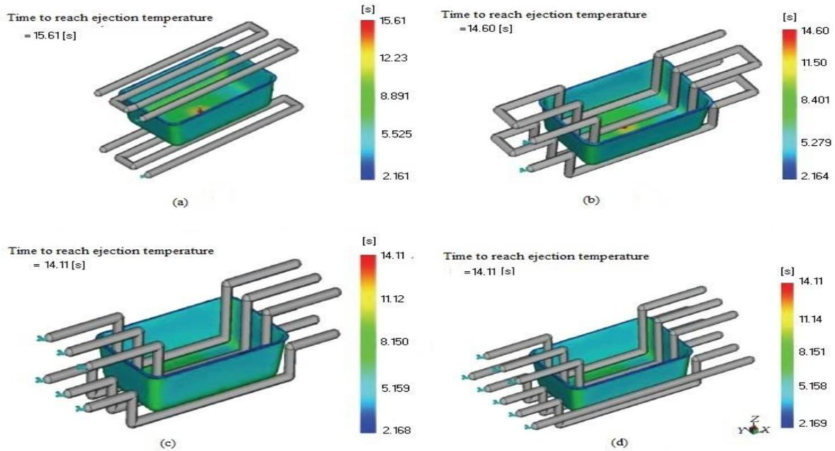
**Figure.4. Time to Reach Ejection Temp (a) CCC (b) SCC (c) PCC (d) CCAL**
