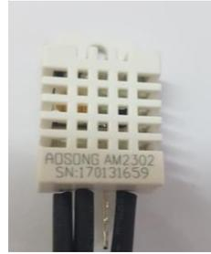
**Figure.3. Air temp.&humidity**
