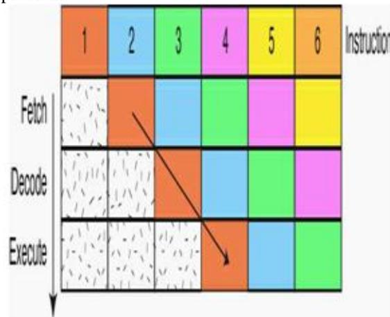
Figure.12. ARM 3-Stage Pipeline
