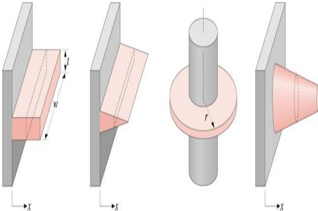
**Figure.2.(A)Straight fin Fig (B).Tapered fin Fig (C).Circular fin Fig (D).Pin fin**
