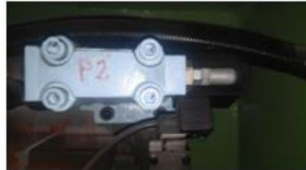
**Figure 2.a.Simple Pressure-Relief Valve**
