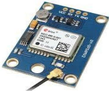
FIG. 5. GPS MODULE FOR SENDING LOCATION
