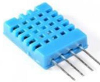
Figure.3. DHT 11 Sensor
