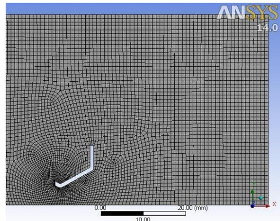
Fig.11 Quadrilateral Mapped Mesh
