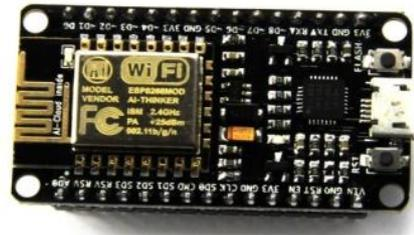
Figure 3. NodeMCU
