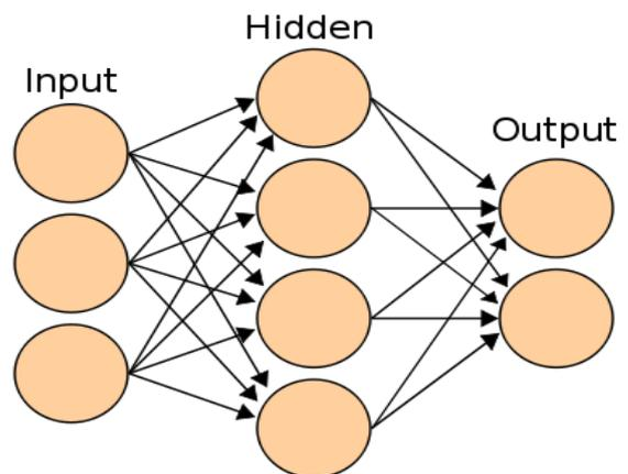
FIG. 3. ARTIFICIAL NEURAL NETWORK LAYER
