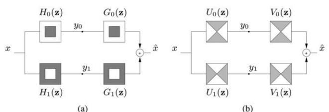
Figure.6. (a) Pyramid NSF B (b) Fan NSF B
