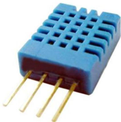
Figure.2. DHT-11 sensor
