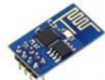
Figure.11. ESP-01 Module
