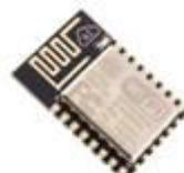
Figure.10. ESP-12 Module
