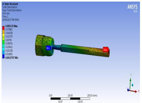
**Figure.8. Deformation in Tie Rod**
