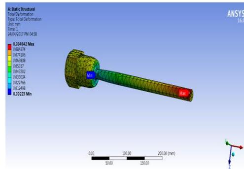
**Figure.10. Deformation in Tie Rod**
