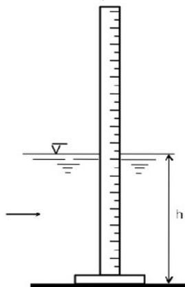
FIGURE 1. LIMNIMETER RULE METER
