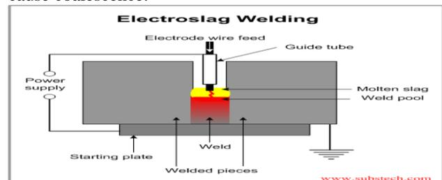
Figure 3.6 Electro slag Welding
