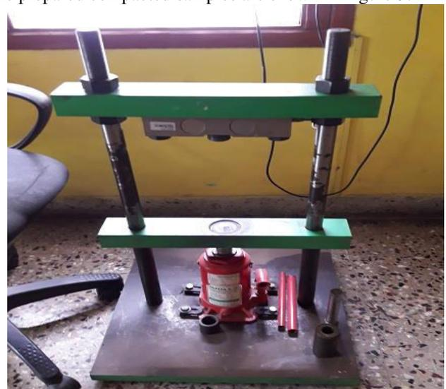
Figure.3.1 Hydraulic punching press
